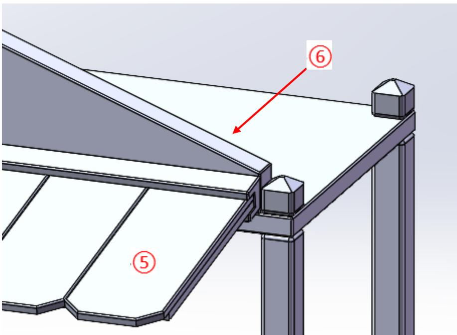
Im Anschluss wird die schräge Seite des Ziegeldaches ⑤ von einer 2. Person in der Montagelage festgehalten und das Ziegeldach „von hinten“ mit der entsprechenden Anzahl Schrauben ⑥ befestigt, je nach Schraubenlänge und -durchmesser und handwerklicher Einschätzung sollte ggf. vorgebohrt werden.
