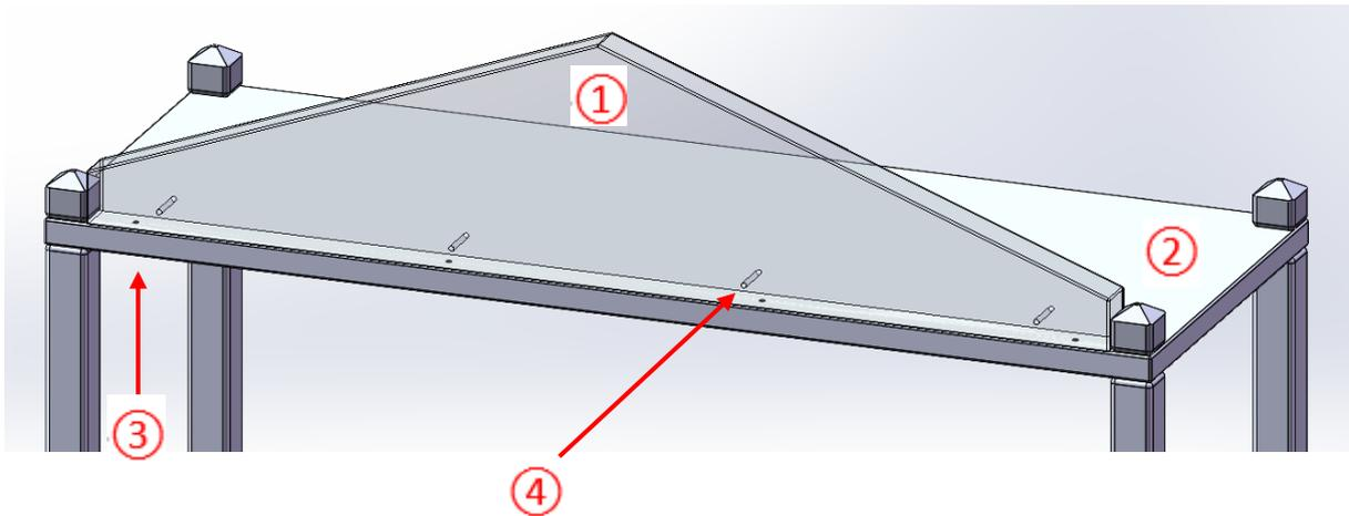
Das rote - sog. Ziegeldach wird optional montiert, die Entscheidung zur Montage fällen unsere Monteure vor Ort nach Absprache mit dem Personal der Einrichtung. Mit dem Dach ist zwar die Optik komplettiert, aber es kann bei engen Raumsituationen oder Aufstellorten in Gehbereichen u. U. die Gefahr entstehen, sich an der auskragenden Platte stoßen zu können.
